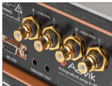
Per Aktivweiche können Subwoofer oder eine Zusatz-Endstufe perfekt angepasst werden.
