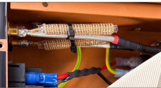
Vier spezielle AARC-Spulen sind direkt an den internen Lautsprecherkabeln angebracht.
